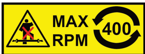
Pas på den roterende aksel! Den maksimalt tilladte omdrejningshastighed og rotationsretningen af kraftudtagets aksel.
